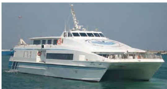
شکل ۱۵- یک شناور کاتاماران با بدنه آلومینیومی
